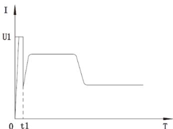
$U_1$  – напряжение толчка (A10) $t_1$  – время толчка (A11)
