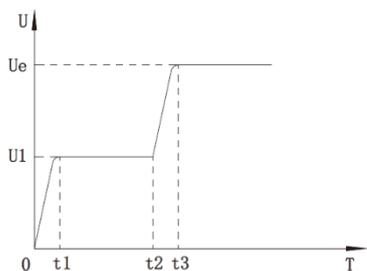
$U_e$  – входное напряжение $U_1$  – поддерживаемое напряжение (A06) $t_1$  – начальное время разгона (A07) $t_2$  – время поддержания напряжения (A08) $t_3$  – время до полного разгона (A09)
